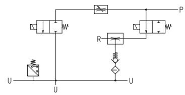
P=CONNESSIONE ARIA COMPRESSA    R=SCARICO    U=CONNESSIONE VUOTO
